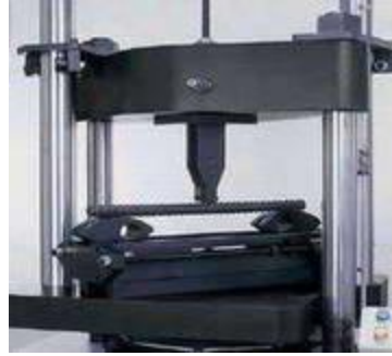
شكل رقم (٣): أحد أنواع المقامع وهو عبارة عن مكبس رأسي يستخدم في ثني الكمر والمقاطع والألواح المصنعة من الصلب.
